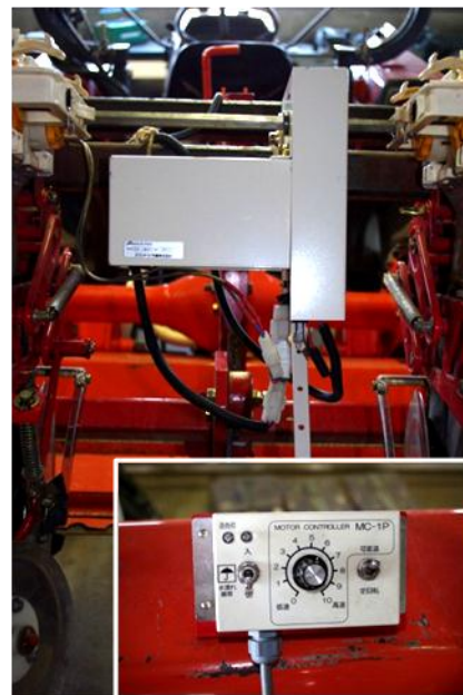
図IV-5 電動コントローラ (右下枠内写真はコントローラ部分)
