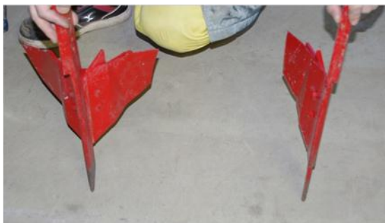
図IV-3 排土板付き畦間サブソイラ (左: 中央用 (両羽根), 右: 両サイド用 (片羽根))
