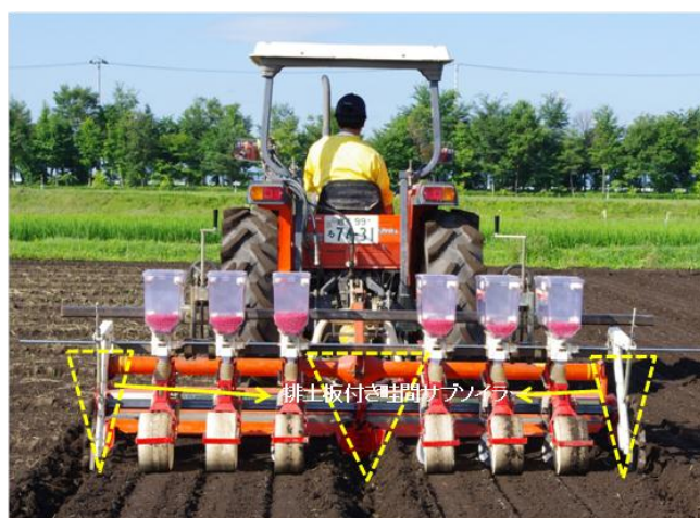
図IV-7 畦立て同時播種機（ソバ仕様（Type2））
