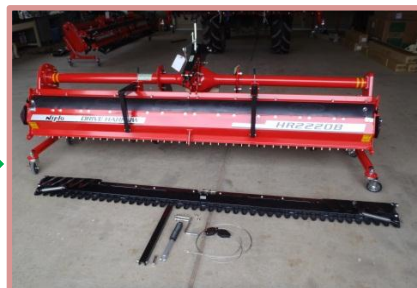
均平板を取り外した状態
