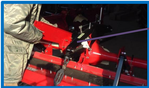
作業機取付バーの装着作業
