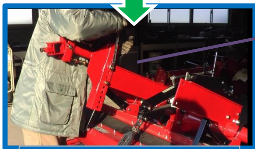
角バー取付用部品の装着作業
