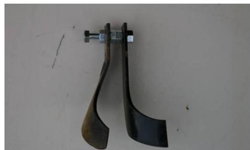
図 II-6 爪形状（左；スライディングカット爪、右；ストレート爪）
