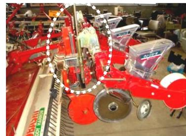
トップリンクの調整や装着用ブラケットの逆向き装着などは、取付バーの種類を問わず、実施可能ですが、嵩上げ用改良取付プレートや市販の嵩上げ用部品を利用できるのは取付バー①のタイプのみですから、取付バーの種類によりこれらの手段を単独もしくは組み合わせることで播種機の位置を十分な高さに設置することが望ましく、コスト等を考えた最適な結合方式を選択して下さい（表Ⅱ-3）。作業機取付バー①のタイプでも、嵩上げ用改良プレートを利用せず、市販純正品とトップリンク調整やブラケット逆向き装着の組み合わせで播種機の高さを確保できるケースもあります。
