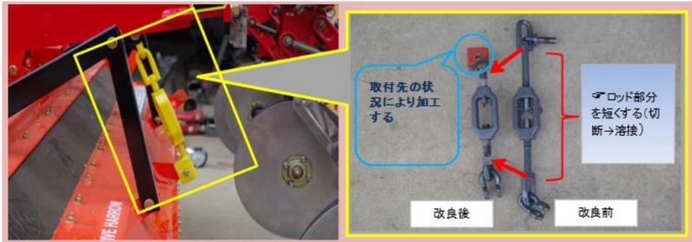
図 II-3 改良型ターンバックルでつり上げたロータリカバー（左）とつり上げ用部品（右、（ターンバックル 左；改良後、右；改良前））
