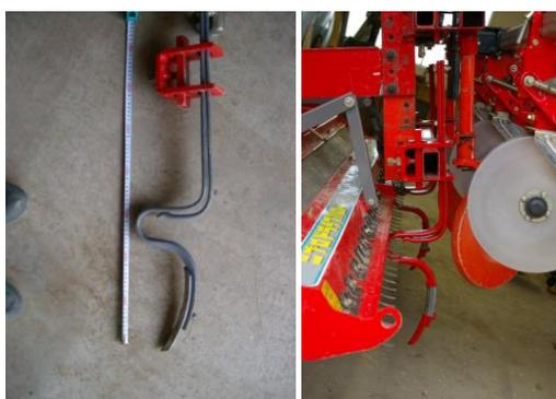
図Ⅱ-24 チゼル爪に用いたトラックローズナ部品(左)と装着した状態(右)
