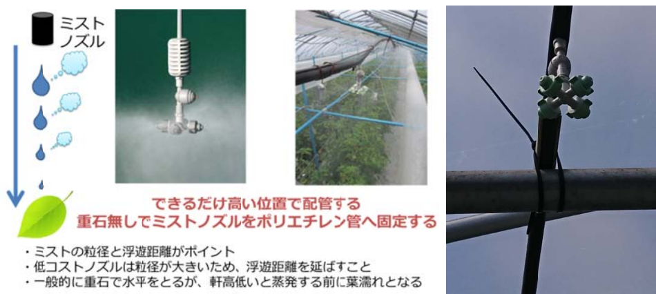
図 42 ノズルの設置方法
