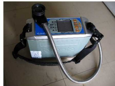
図35 携帯型近赤外線分光分析装置 クボタ製「フルーツセレクター」
