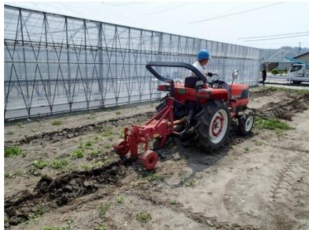
図 19 サブソイラ施工による透水性改善
