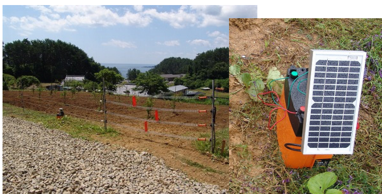
図 電気牧柵(フェンシングワイヤー)設置園地とソーラー式電牧器
