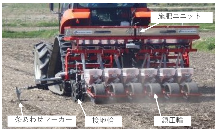
図 1 高速高精度汎用播種機(形式：NTP-6AF、6 条) (農研機構 農業技術革新工学研究センター・アグリテクノ 矢崎(株)共同開発)
