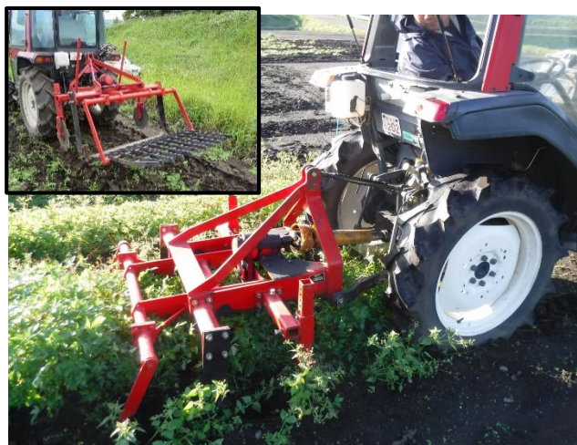
写真3 リフター型掘取機による 掘上作業風景 (左上は掘取機全景)
