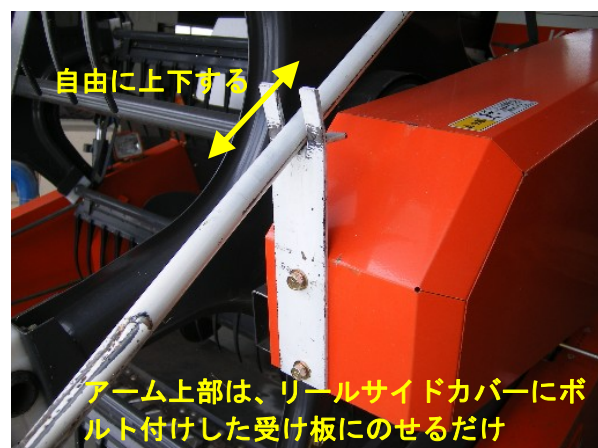
図26 デバイダ改良のため作成したアームのコンバインへの取り付け
