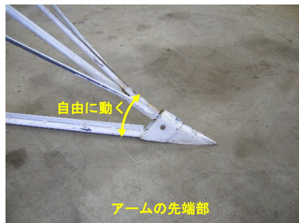
図25 デバイダ改良のため作成したアームの構造
