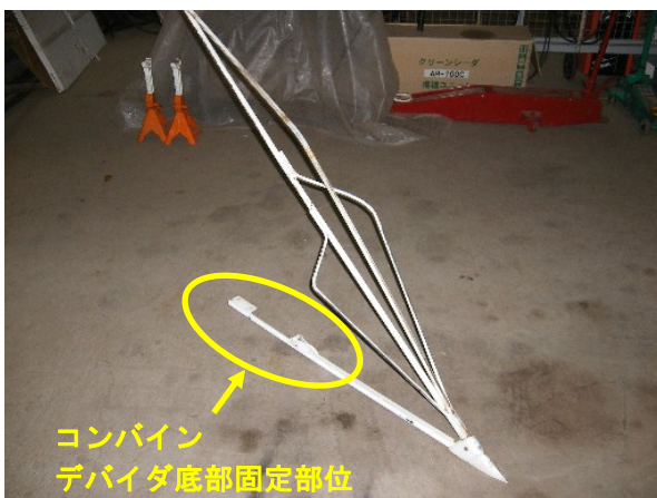
図25 デバイダ改良のため作成したアームの構造
