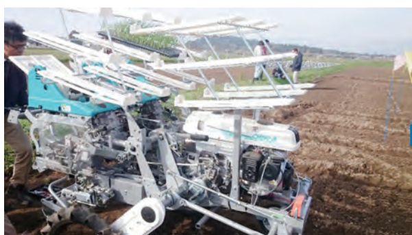
写真16 歩行型全自動移植機(うね立て用)
