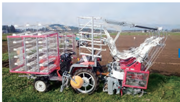
写真18 乗用型全自動移植機(平うね用)
