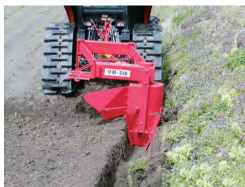
写真10 スクリューオーガ式溝掘機
