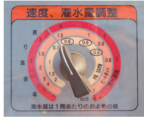
写真8 かん水装置の灌水調整ダイヤル
