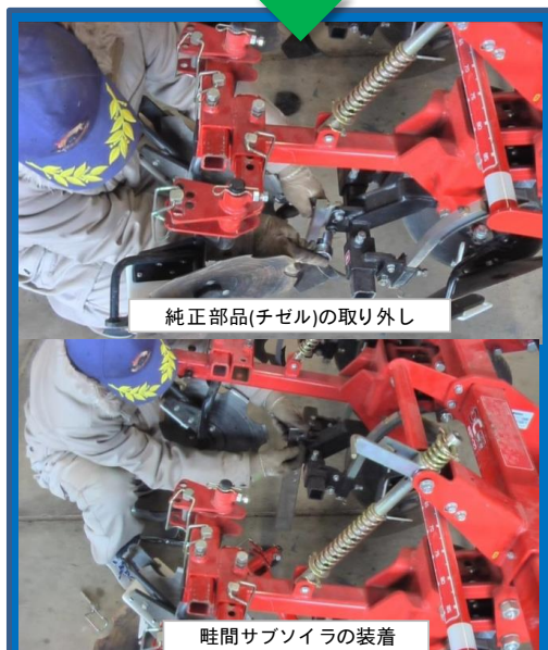
純正部品の取り外しと畦間サブソイラの装着作業
