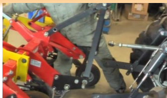
ディスク式除草機の取り外し作業
