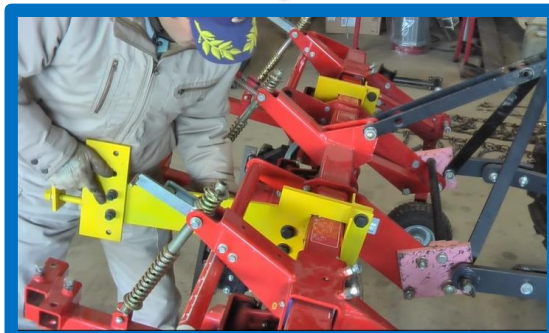
播種機装着用アタッチメントの装着作業
