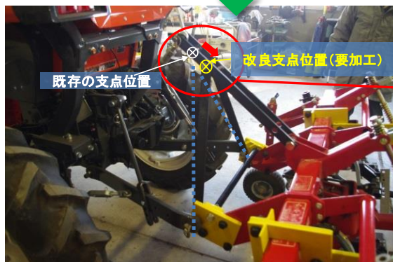
短縮用ヒッチ補完部品が移植されたディスク式畦立て播種機
