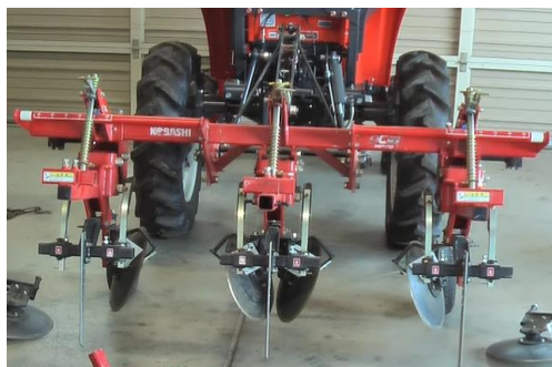
前部の両端ディスクと後部ディスクが取り外された状態のディスク式除草機
