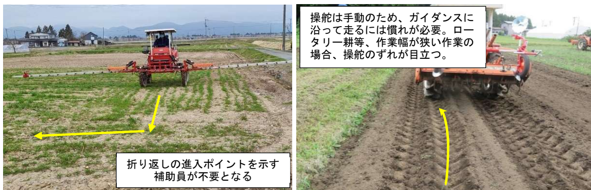
図2 ガイダンスシステムと組み合わせた現地での実証状況 (ハイクリブームによる防除作業等、作業幅の広い作業が適している)
