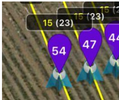
図 2 DEM情報を基に地表面からの飛行高度を一定に調整 (高度15m設定だが、23mに自動補正されている) (Litch for DJI)
