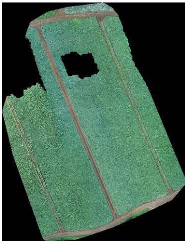
図 1 従来法で傾斜地撮影した画像を基に作成したオルソ画像 (不完全な画像)
