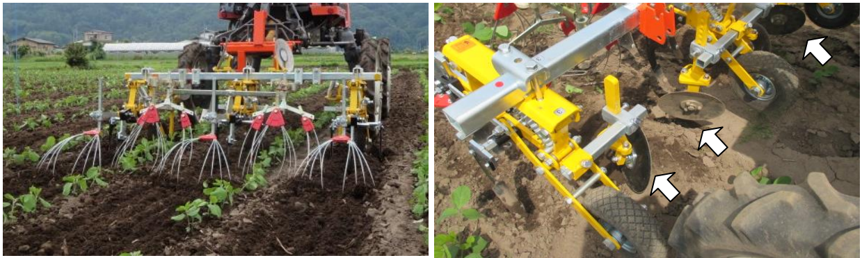
図1 レーキ式除草機による除草状況(左: R1. 7. 3)とディスク装着状況(右)
