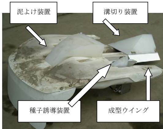
図1 開発した作溝同時直播装置
