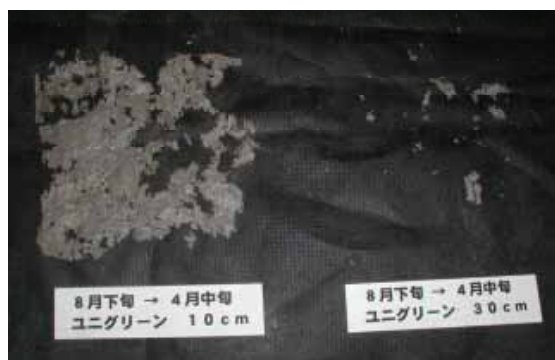
写真 - 1 埋設によるマルチ分解状況 ユニグリーン 8月下旬 4月中旬 左10cm、右30cm埋設
