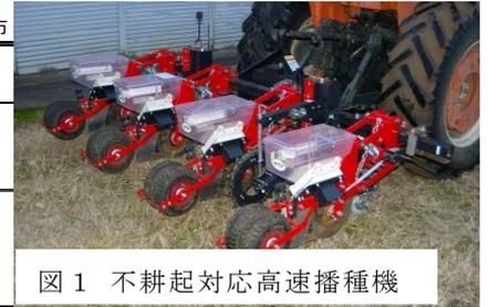
図1 不耕起対応高速播種機
