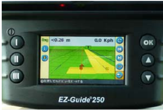
写真 トラクタ搭載型 GPS(左：モニタ画面，右：作業状況)
