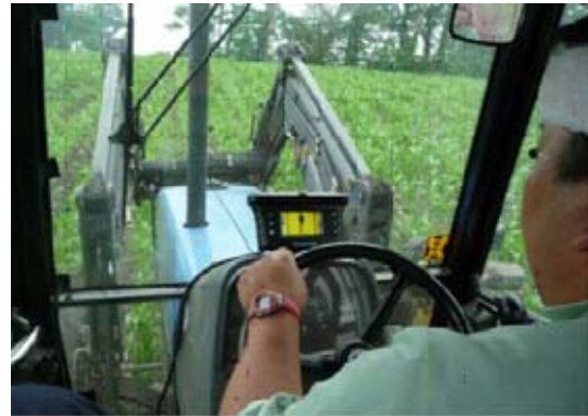
写真 トラクタ搭載型 GPS(左：モニタ画面，右：作業状況)
