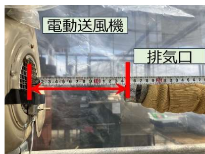
図2 小型光合成促進機と電動送風機の設置方法がダクト内とハウス内との温度差に与える影響(R5. 5. 20 横風再現時)(左)と小型光合成促進機と電動送風機の設置方法(R5. 5. 20 換気時)(右)
