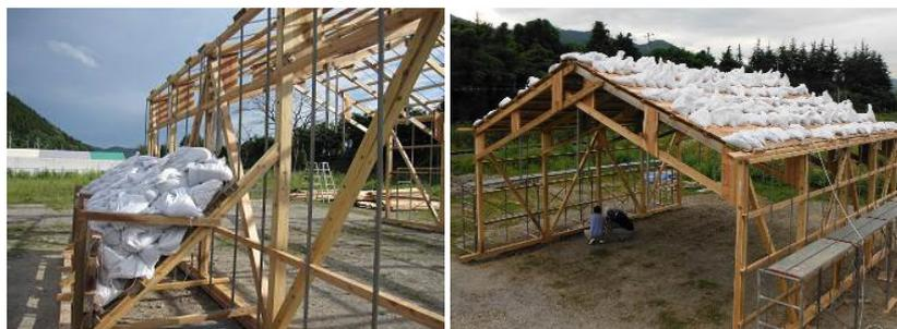
図 2 木骨ハウスの耐風雪試験 左: 耐風性試験 右: 耐雪試験
