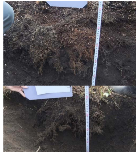
図2 マルチ資材連用12年目の根の状態（上：土改(チップ) + マルチ(チップ)、下：土改無 + マルチ無）
