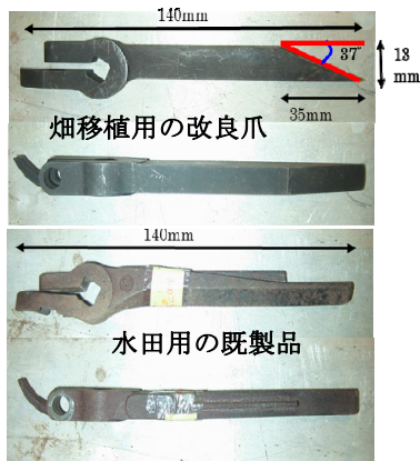
図1 移植爪の改良 (県北研が設計、岩手大学で鉄の鋼材(SS400)を加工)
