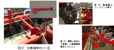
図21 作業機取付バーQ
