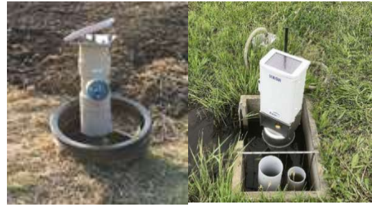
図2 ほ場水管理システムの子機
