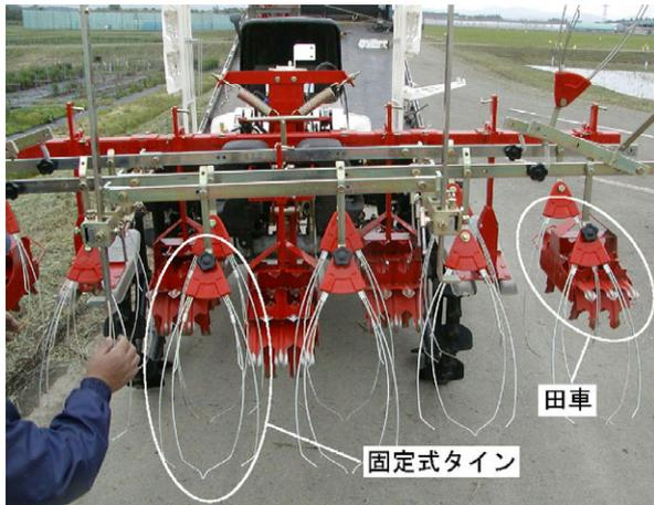
図1 固定式タイン型除草機(M社製水田除草機LWV-6)
