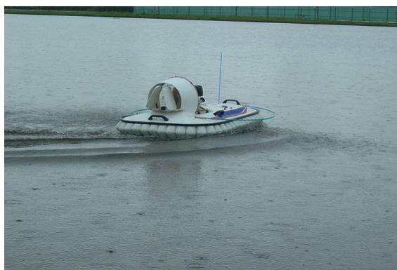
図1 ラジコン船-クワによる除草剤散布
