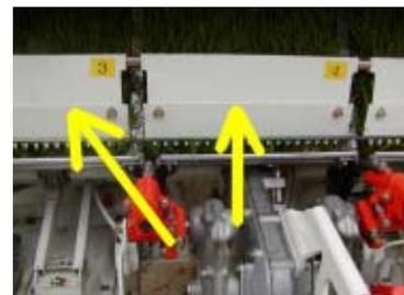
写真3 田植機の苗押さえ装置
