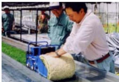
写真2 巻き取り補助装置
