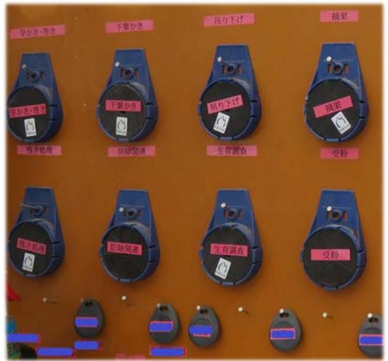
写真1 作業内容・作業者識別 IC タグ
