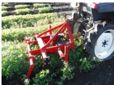
図3 リフター型掘取機による掘上げ
