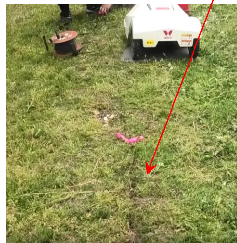
エリアワイヤー埋設部分
