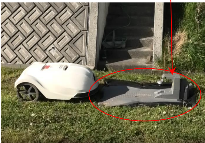
充電ステーション
