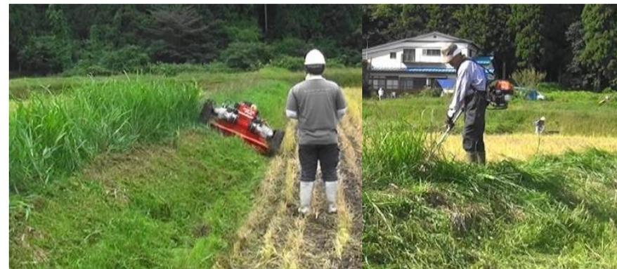
写真2 遠隔操作草刈機と刈払機の組合せ作業
