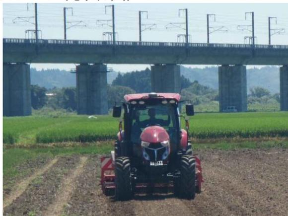
【写真 自動操舵システムによる手放し運転】
