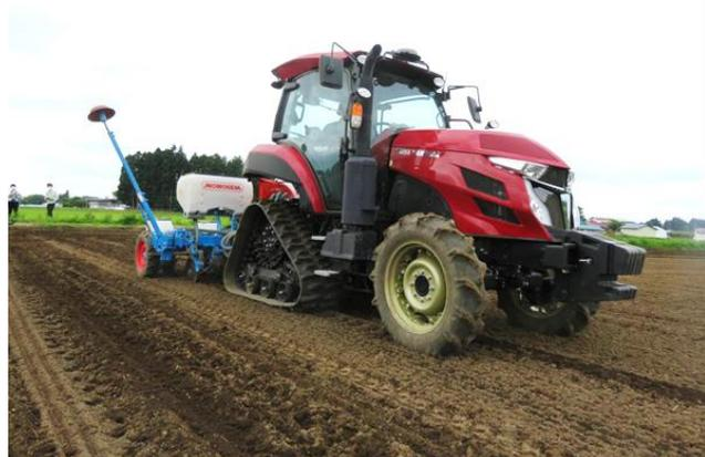
写真 V-NeKHs の位置補正データを使った播種作業
