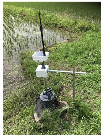
写真:給水ゲート(左)、自動給水バルブ(右)
