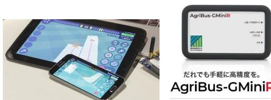
左：ガイダンス端末 右：2周波 RTK-GNSS 受信機
