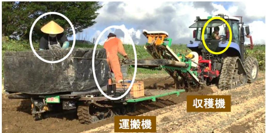
図3 運搬機導入後 (3人作業)
