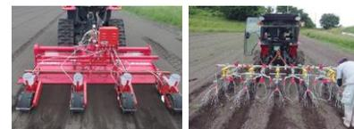
写真3 4条真空播種機(左)と4条レーキ式除草機(右)
