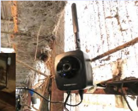
自宅から離れた牛舎にWi-Fi接続のカメラを設置。中継機でWi-Fiを延長し、どこからでもスマートフォンで分娩を看視。
