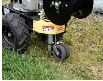
写真2 エリアワイヤーの埋設
