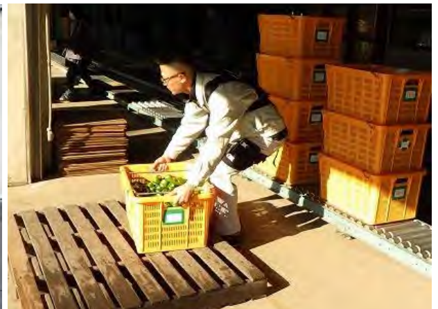
写真5. エアロバックを使用し、ピーマンコンテナを移動させる様子。
