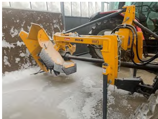
明渠施工用 溝堀機（約25cm深） ドンディ D35B
