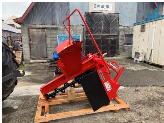
暗渠施工用 溝堀機（約60cm深） ニプロ OM1000A
