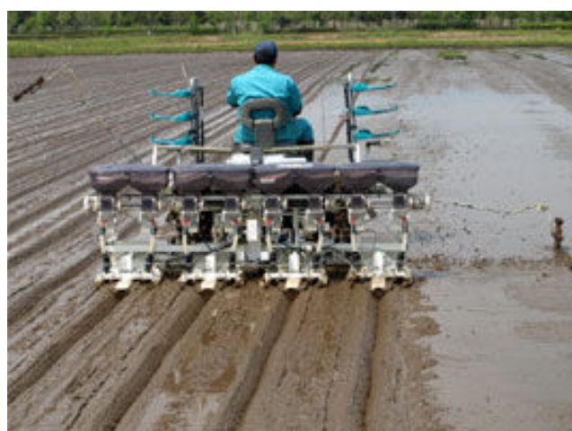
県農業研究センターで 昨年度開発された「作溝同時直播機」
