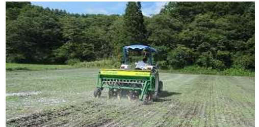
簡易草地更新機の稼働の様子(条溝が付けられ、牧草種子が播種されています)
