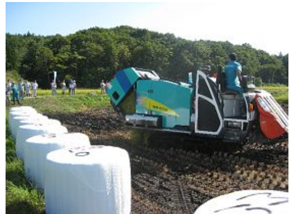
稲WCS専用収穫機による 収穫作業実演
