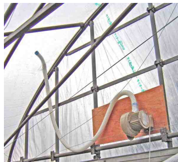
図1 保温性向上技術 空気膜2重構造ハウスに空気を送り込むブロー
