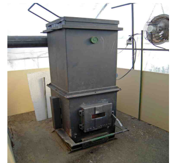
図2 代替エネルギー利用技術 チップ・薪兼用暖房機 (比較的小規模なハウスに適する)
