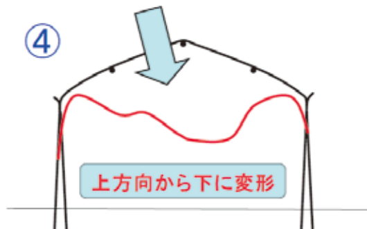
④真上から屋根が押しつぶされたように陥没
