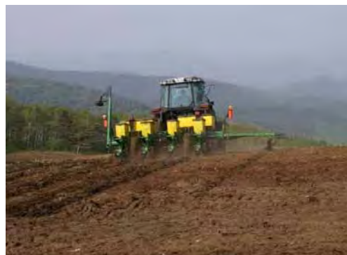
不耕起播種機によるトウモロコシの播種
