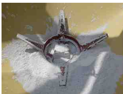
タンク内でのブリッジ防止に有効なステアリングデバイス
