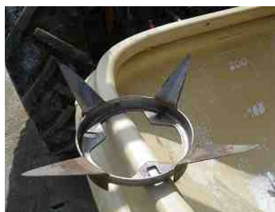
タンク内でのブリッジ防止に有効なステアリングデバイス
