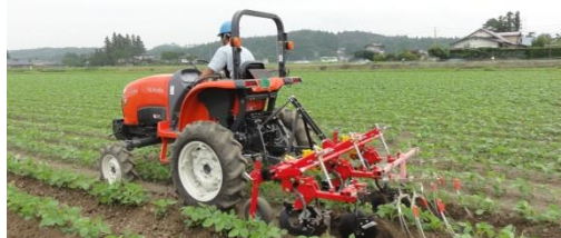
写真1 農業研究センター開発の改良型ディスク中耕除草機
