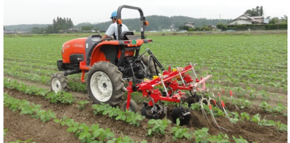
写真1 農業研究センター開発の改良型ディスク中耕除草機
