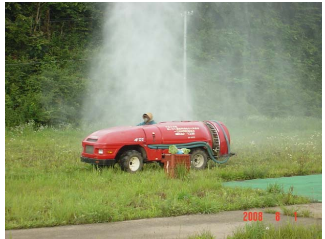
画像2 スピードスプレーヤの遮風板による飛散防止対策実証
