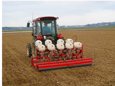
ロータリーハローシーダーによる乾田直播の播種作業
