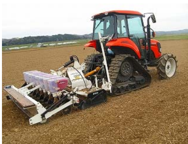
バーチカルハローシーダーによる乾田直播の播種作業
