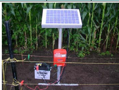
写真2 設置後のソーラーパネルと電牧機本体
