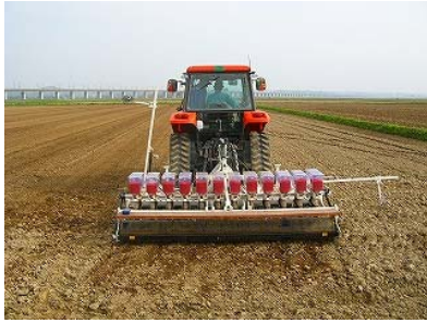
現地導入された バーチカルハローシーダー による乾田直播の播種作業
