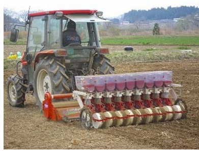
現地実証圃での ドライブハローシーダー による乾田直播の播種作業
