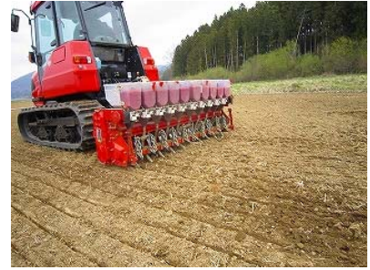
現地実証圃での V溝播種機による 乾田直播の播種作業
